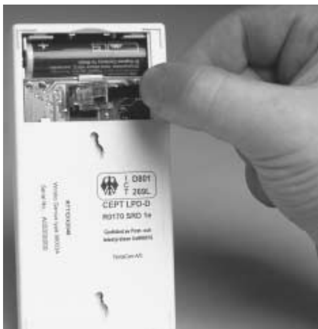
Fig 7.1 Rumstermostatens anslutningskontakt/ Rumstermostatens tilslutningskontakt
